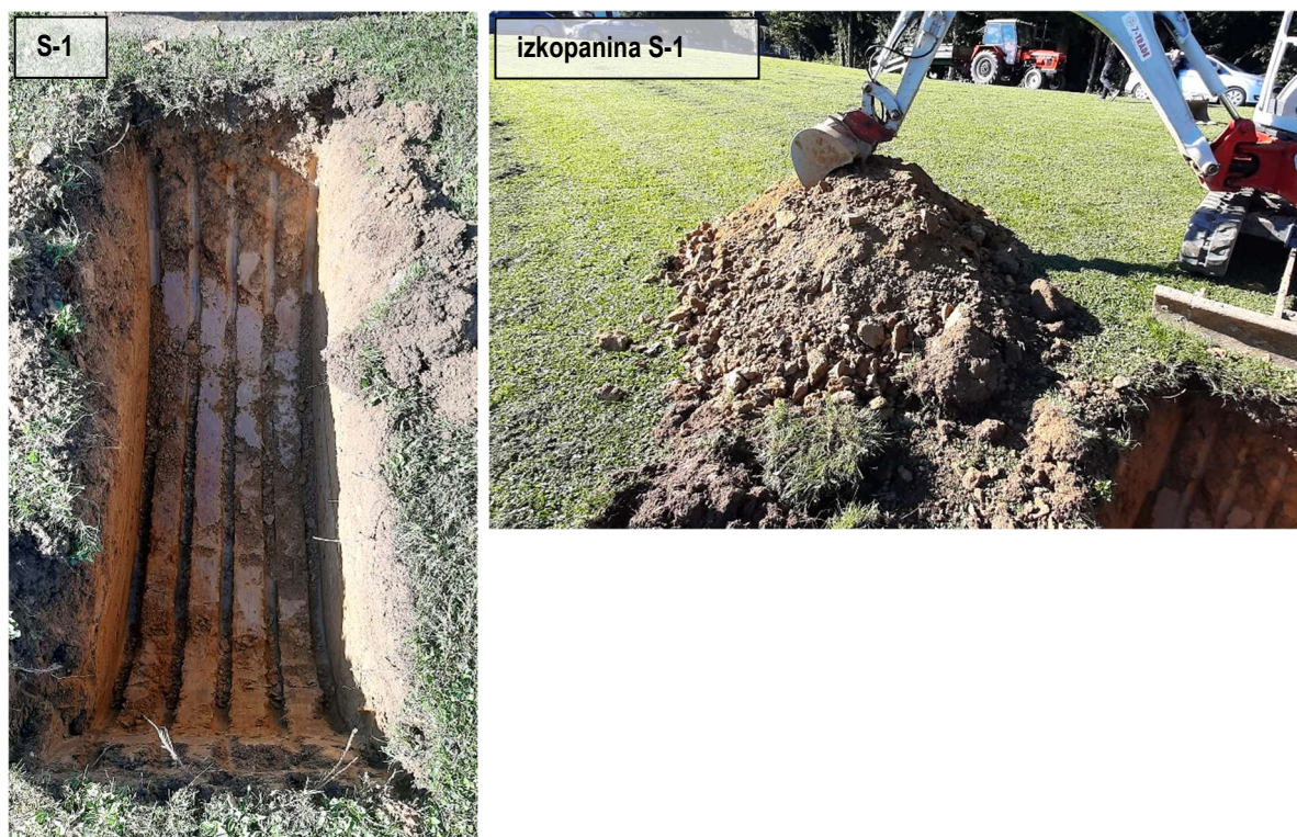
Slika 6: Sondažni izkop S-1 na območju jugovzhodnega vogala predvidenega stanovanjskega objekta ter izkopanina izkopa (globina zbitega, rahlo meljastega peska in peščene gline, 1,0 m pod površjem)
